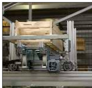
En færdigmonteret stige fra en monteringsarbejdsplads suser af sted mod bufferlageret.
