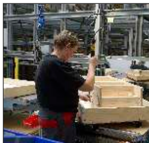
Stige og loftslem samles ved monteringsarbejdspladsen.
