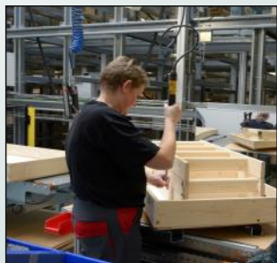
Stige og loftslem samles ved monteringsarbejdspladsen.
