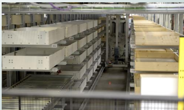
En lagerrobot lægger halvfabrikata på bufferlager.
