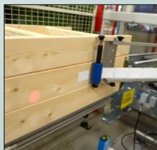
Halvfabrikata mærkes med RFID-chips, så man er sikker på altid at få dem sat sammen til den rette variant.
